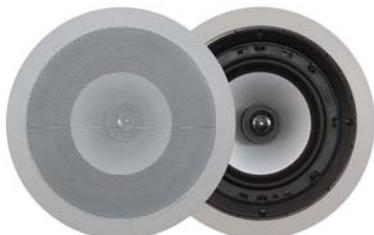
L'enceinte EMOTION 6 RO est un système 2 voies haut-de-gamme, qui fait appel à un puissant woofer à cône en aluminium de 6,5" et un tweeter haute puissance refroidi par ferrofluide avec une calotte en aluminium de 0,75".
