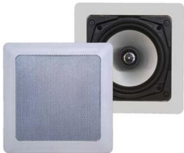
L'enceinte EMOTION 5 SQ est un système 2 voies haut-de-gamme, qui fait appel à un woofer à cône en aluminium de 5,25" et un tweeter haute puissance refroidi par ferrofluide avec une calotte en aluminium de 0,75".
